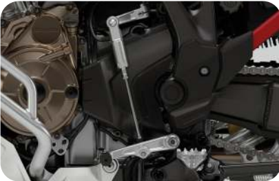
QUICKSHIFTER 08U70-MLG-E00 CHF 295.00 08U70-MLG-E00 Der Schalthebel ermöglicht ein sanftes und sofortiges Hoch- und Herunterschalten ohne Kupplungsbe-tätigung, wodurch die Belastung des Fahrers bei Langstrecken-Abenteuertouren verringert und die Sportlichkeit erhöht wird. Mit AUTO-BLIP Funktion für nahtloses Herunterschalten. (Nur für Schaltge-triebeversion).
