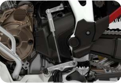
QUICKSHIFTER 08U70-MLG-E00 CHF 295.00 Der Schaltautomat ermöglicht ein sanftes und sofortiges Hoch- und Herunterschalten ohne Kupplungsbetätigung, wodurch die Belastung des Fahrers bei Langstrecken-Abenteuertouren verringert und die Sportlichkeit erhöht wird. Mit AUTO-BLIP-Funktion für nahtloses Herunterschalten. (Nur für Schaltgetriebeversion).
