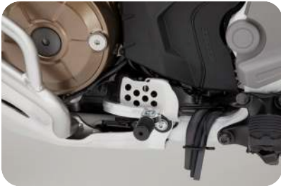
DCT FUSSSCHALTHEBEL 08U70-MKS-E50 CHF 465.00 Mit diesem Kit kann der Fahrer die Gänge im traditionellen Format 1 unten – 5 oben mit dem linken Fuss schalten. Es funktioniert zusammen mit den Schalthebeln am Lenker, sodass der Fahrer jederzeit zwischen beiden wählen kann. (Nur für DCT-Version).
