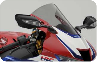
HOHER WINDSCHILD 08R70-MKR-D10ZA / 08R71-MKR-D10ZA CHF 79.00 Der Hoher Windschutz wurde nach Windkanal- und Realfahrten entwickelt und kombiniert erhöhten Windschutz mit verbesserter Motorradkontrolle. Im Vergleich zur Standardversion ist die Oberseite des Windschilds 8 mm höher und 40 mm weiter vorne angebracht. Ausserdem ist es als Original-Honda Design vollständig WVTA-zertifiziert. 2 Versionen erhältlich: • 08R70-MKR-D10ZA: Rauch • 08R71-MKR-D10ZA: Durchsichtig
